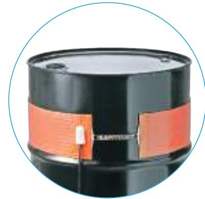
Las mantas calefactoras se fabrican bajo pedido y sus dimensiones y formas pueden por lo tanto adaptarse a cada situación. La fijación puede efectuarse mediante ojales o ganchos incorporados a la manta calefactora y, en algunos casos, podemos realizar nosotros mismos una vulcanización directa en sus piezas metálicas. También es posible incorporar una capa adhesiva.
