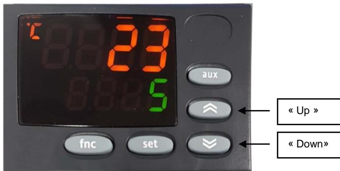
Achtung: wenn der Code « **E1** » auf dem Display blinkt, Überprüfen Sie den Anschluß des Messfühlers. Dieser Fehler löst den Alarm aus.
